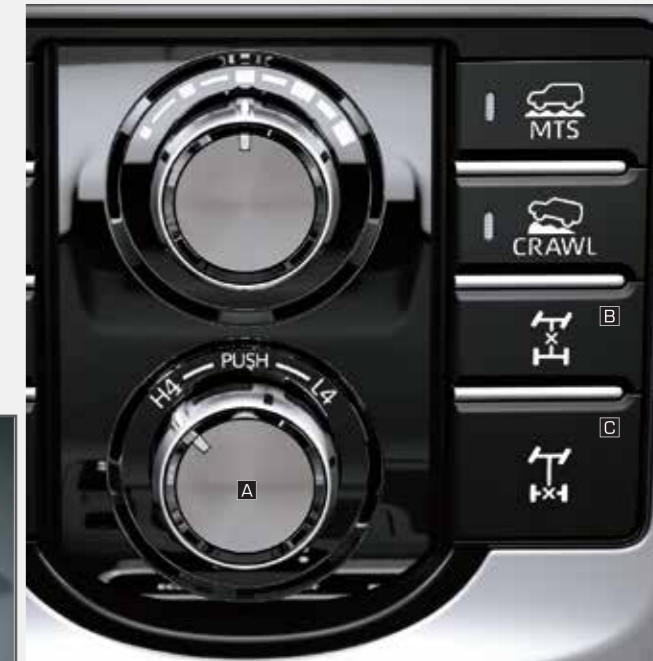
مفتاح إقفال الترس التفاضلي المركزي A مفتاح إقفال الترس التفاضلي المركزي B مفتاح إقفال الترس التفاضلي الخلفي C Rear differential lock switch C Center differential lock switch B Transfer switch A
